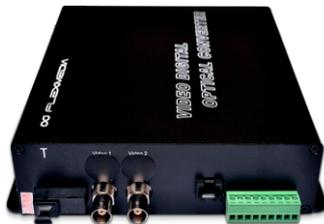
Converte o sinal de vídeo analógico e dados (serial e ethernet) em óptico e a transmissão deste sinal em meio óptico; bem como a recepção e conversão do sinal óptico em analógico, utilizando fibra monomodo com possibilidade de instalação em sub-rack ou stand alone.
