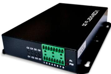
Permite a conversão de sinais de contato seco em sinal óptico e a transmissão destes sinais em meio ópticos, através de fibras monomodo ou multimodo e posteriormente a recepção e conversão desse sinal óptico em elétrico.
